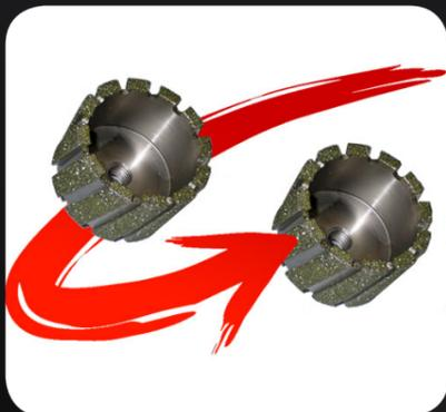
Bei galvanischen Werkzeugen bleibt die Geometrie des Grundkörpers durch einschichtige Belegung konstant. Dadurch wird ermöglicht, auch tiefliegende Bereiche über einen sehr langen Zeitraum bearbeiten zu können. Gleichzeitig entsteht eine nur sehr geringe Staubentwicklung.
